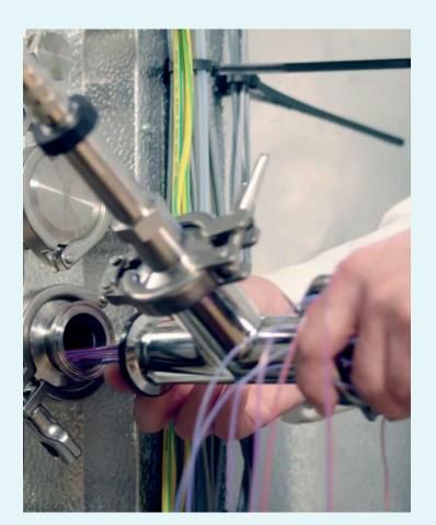
La Qualifica delle prestazioni valuta l'efficacia della sterilizzazione dell'autoclave in condizioni di carico reali, utilizzando indicatori biologici e altri strumenti di convalida per fornire una misura diretta della sterilità.
