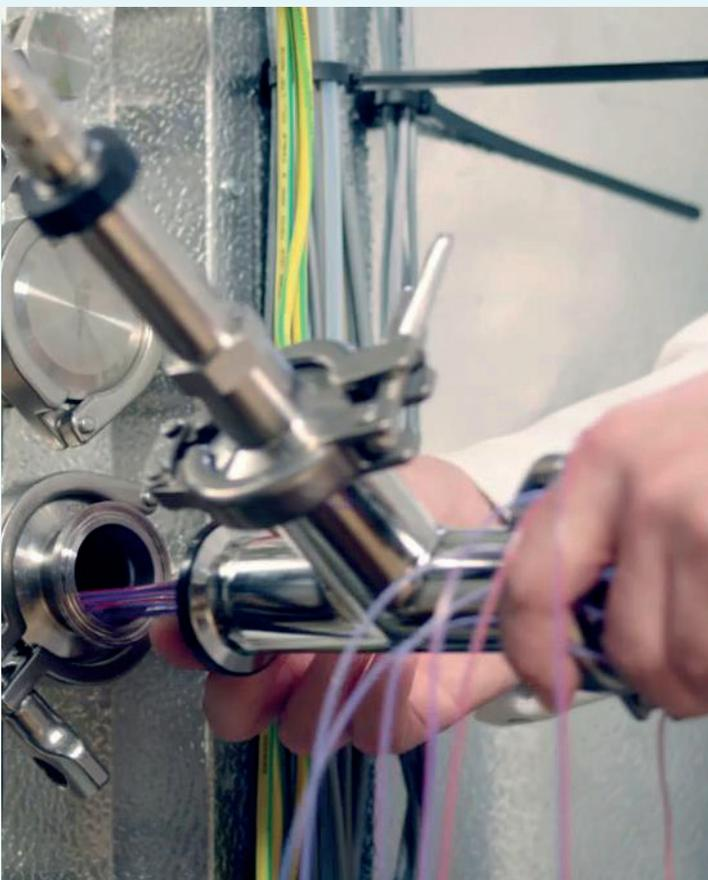
Bei der Leistungsqualifizierung wird die Sterilisationswirksamkeit des Autoklaven unter tatsächlichen Beladungsbedingungen mit biologischen Indikatoren und anderen Validierungsinstrumenten bewertet, um ein direktes Maß für die Sterilität zu erhalten. Diese Tests bestätigen, dass der Autoklav die geforderten Sterilitätssicherheitsniveau (SAL) durchgängig erfüllt.
